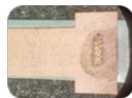
软包电池极耳 Lug laser welding
